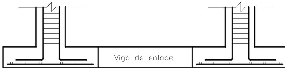
*Dos zapatas unidas con viga de enlace*
